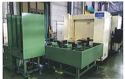
横型マシニングセンタ(最大加工径 600mm)
