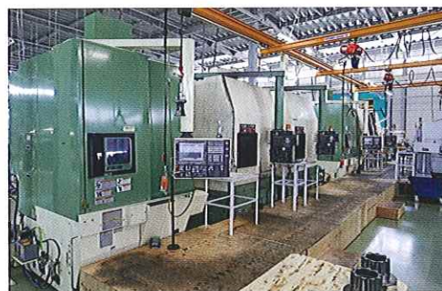
縦型NC旋盤ライン(最大加工径 600mm)
