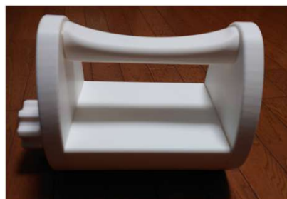
図 付加製造技術を用いて製作した運動促進器具
